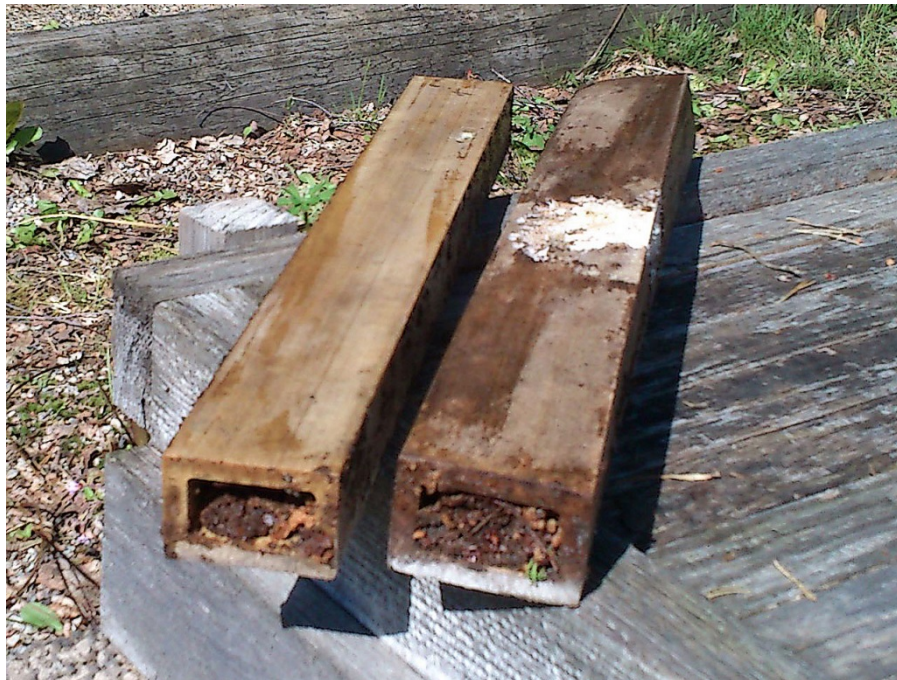
Figur 2. Träplastkomposit (WPC) exponerade i testbädden i Borås. Bilden visar rötangrepp efter 7 års exponering ovan mark i "Horisontal Double layer" test.
