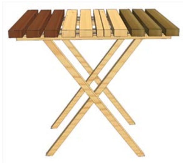
Figur 4. Försöksrigg med tre olika trämaterial bestående av obehandlad ek, obehandlad gran och termiskt modifierad gran.
