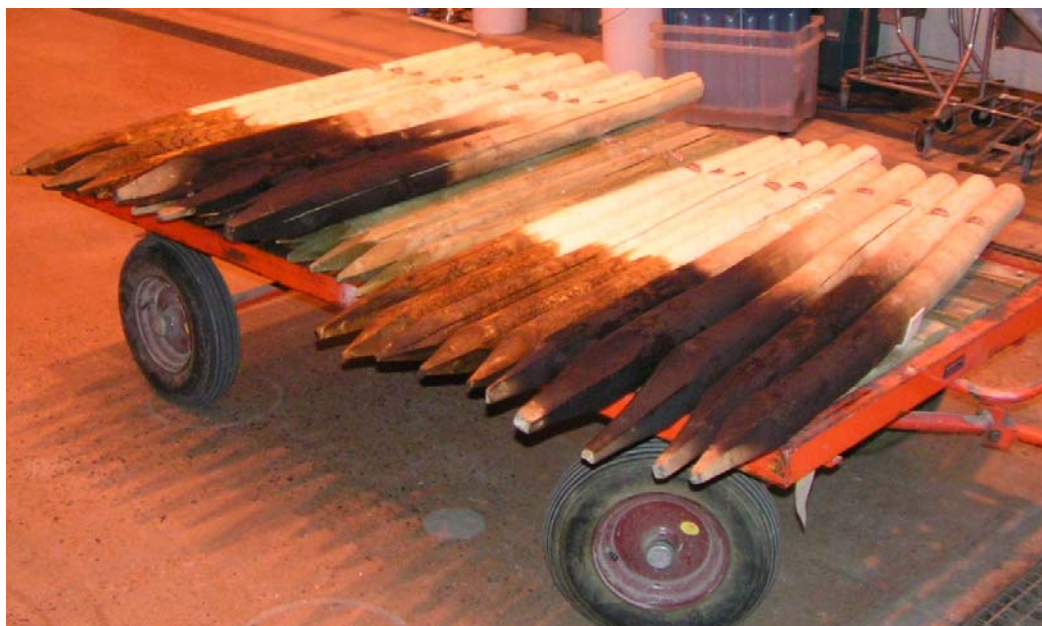
Figur 2. De kolade (mörkaste spetsar) och stubboljebehandlade stängselstolparna före utsättning på fältet.
