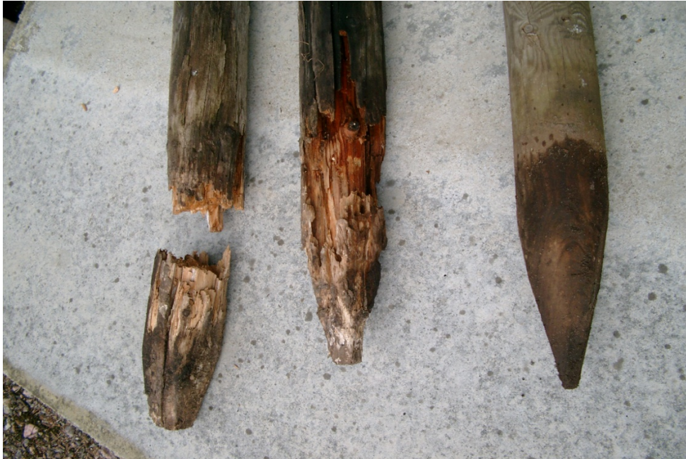
Figur 4. Senvuxen gran, senvuxen furu och CCA-impregnerad furu efter 7 års exponering i försöksfältet i Borås (foto från Träskyddsnytt nr 16, 2004).
