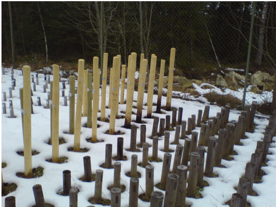
Figur 1. SPs försöksfält med provning av stängselstolpar.
