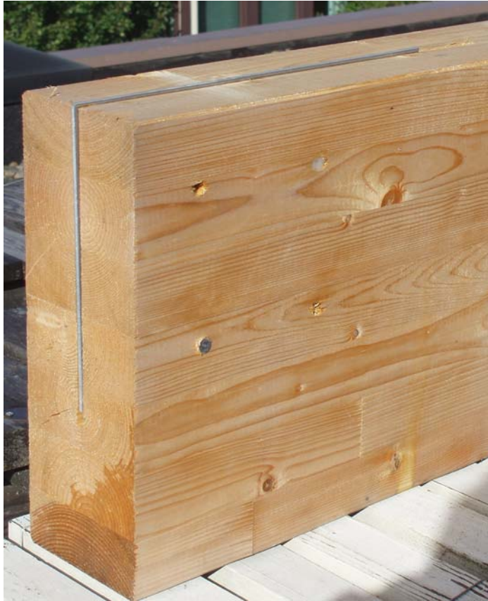
Figur 6. Foto av provkropp med aluminiumplåt och dymlingar.
