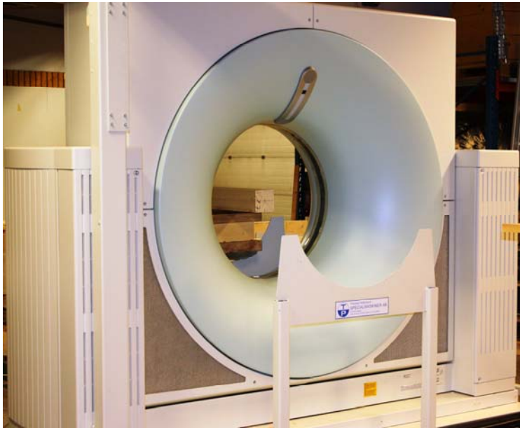
Figur 1. Bild av tomograf Siemens Somatom Emotion Duo. I mitten av öppningen ligger provkroppen.
