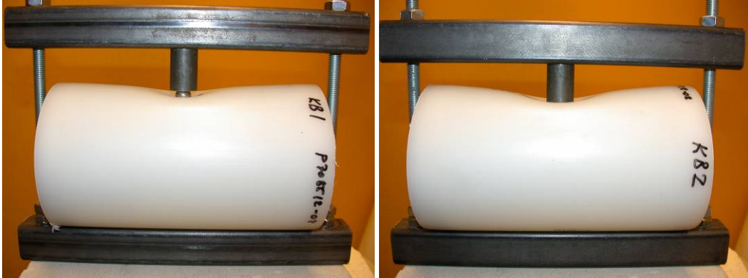
Figur B2-9. Prov KB1 med 15 % kulintryckning i icke åldrat material B, bild (a) och prov KB2 med 25 % kulintryckning i icke åldrat material B, bild (b).
