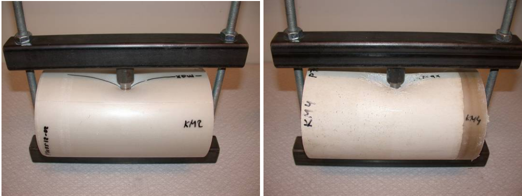
Figur B2-12. Prov KM2 med 25 % kulintryckning i icke åldrat material M, bild (a) och prov KM4 med 25 % kulintryckning i åldrat material M, bild (b).
