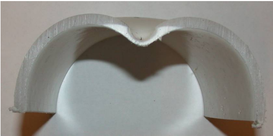
Figur B2-25. Prov KB2 kulintryckning 25 % i icke åldrat material B.
