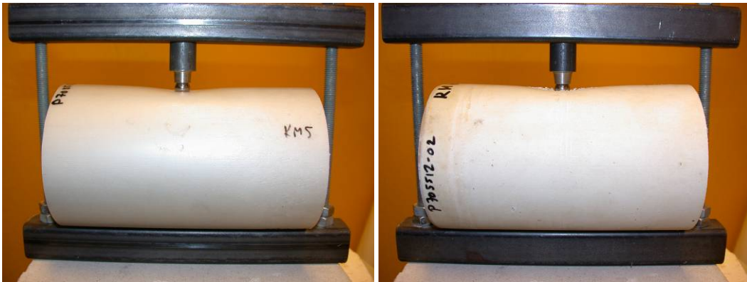
Figur B2-13. Prov KM5 med 10 % kulintryckning i icke åldrat material M, bild (a) och prov KM6 med 10 % kulintryckning i åldrat material M, bild (b).
