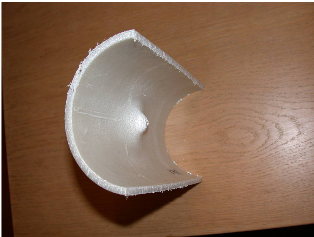
Figur B2-20. Prov KM2 med 25 % kulintryckning i icke åldrat material M.
