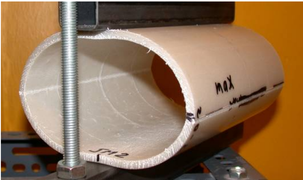
Figur B2-6. Ovaliseringsprov JM2 med notchdjup 20 % i icke åldrat material M.
