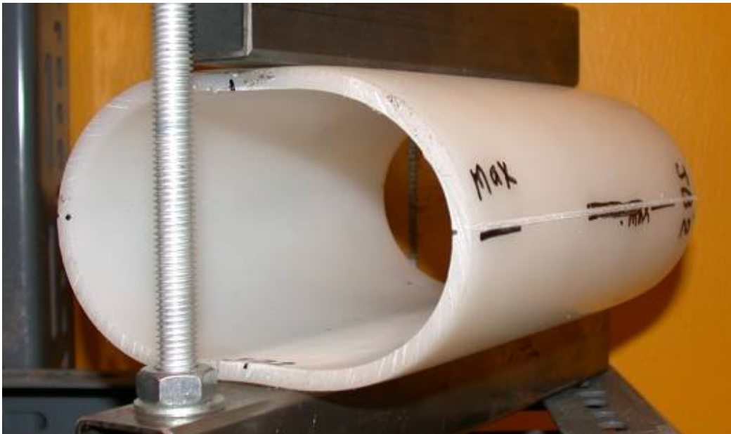
Figur B2-2. Ovaliseringsprov JB2 med notchdjup 20 % i icke åldrat material B.
