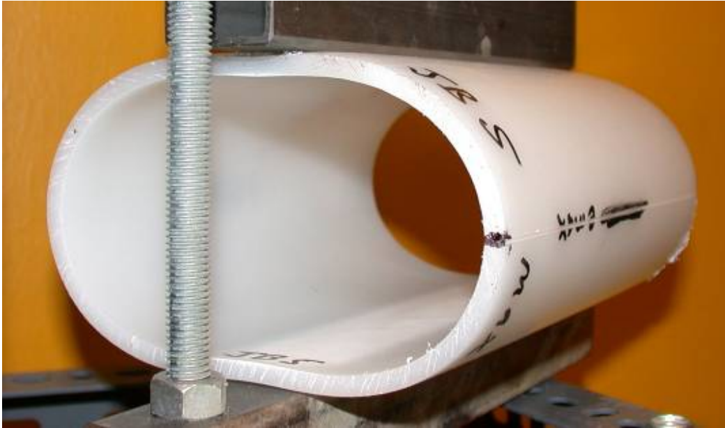
Figur B2-1. Ovaliseringsprov JB5 med notchdjup 10 % i icke åldrat material B.
