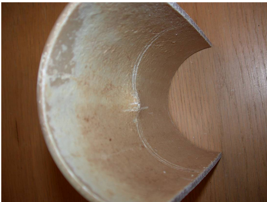
Figur B2-21. Prov KM6 med 10 % kulintryckning i åldrat material M.
