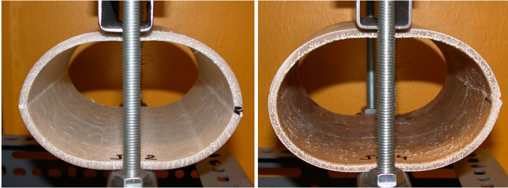
Figur 4-5. Sprickbildning på insidan mitt för 20 % notcharna i prov JM2 bild (a) och i prov JM4 bild (b).
