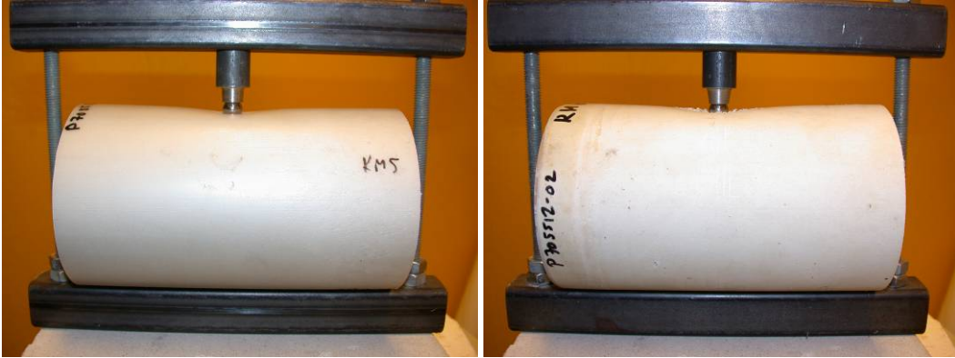
Figur 4-14. 10 % intryckning i icke åldrat prov KM5 bild (a) och 10 % intryckning i åldrat prov KM6 bild (b).
