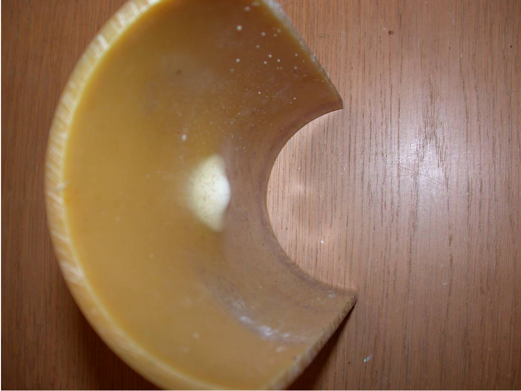
Figur B2-16. Prov KB3 med 15 % kulintryckning i åldrat material M.
