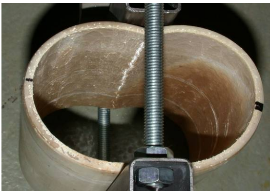
Figur 4-6. Sprickbildning i taket på prov JM3.
