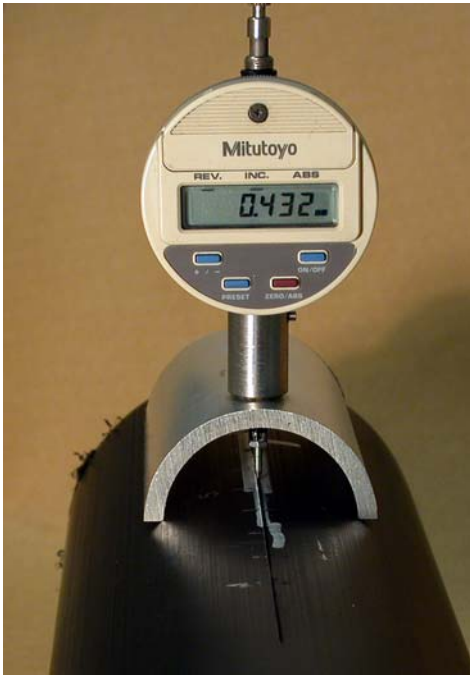
Figur 6-1. Repdjupsmätaren på ett 110 mm rör med repa.
