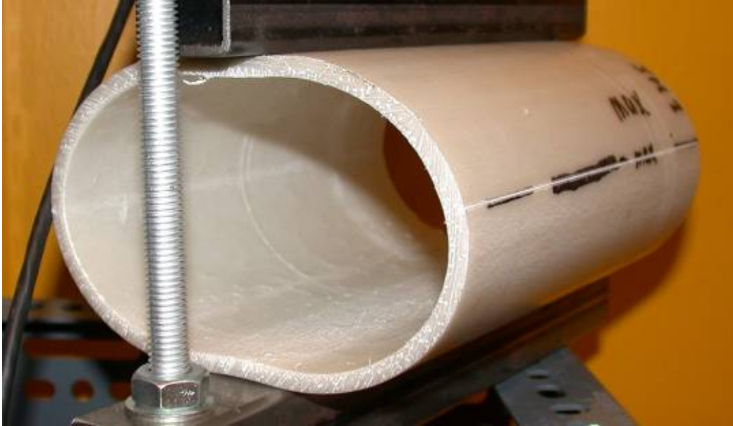
Figur B2-5. Ovaliseringsprov JM1 med notchdjup 10 % i icke åldrat material M.
