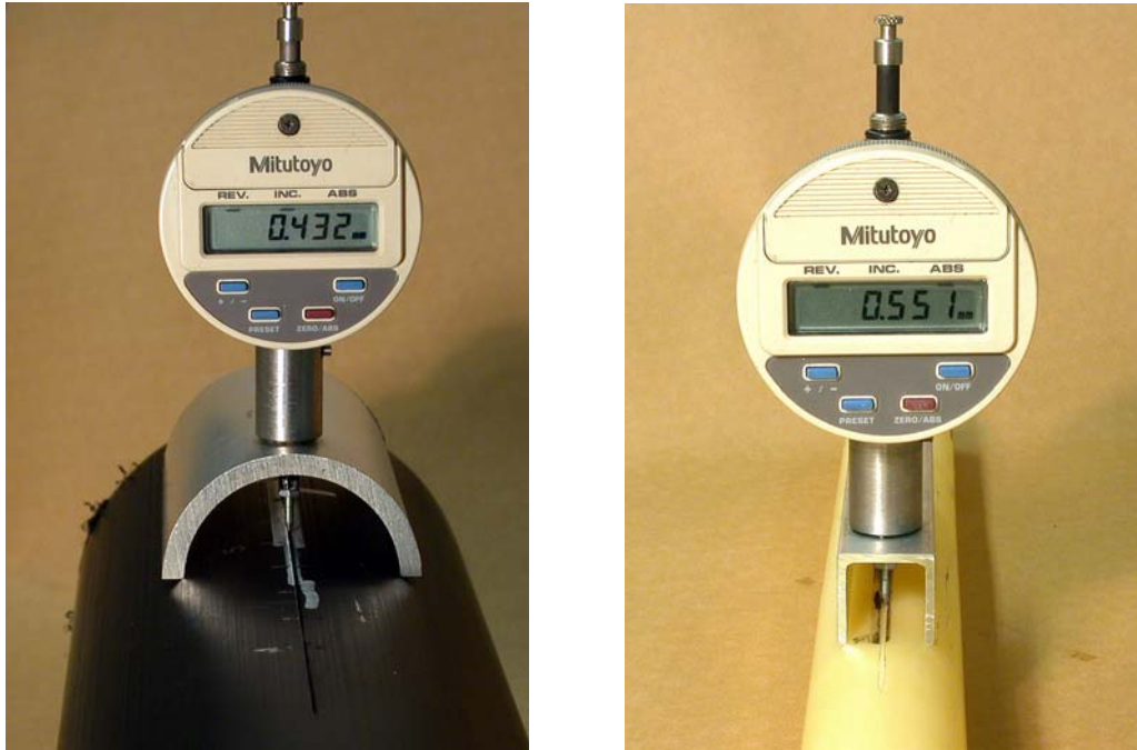
Figur B4-1. Repdjupsmätare för rör > 110 mm (a) samt för rör mellan 32 mm – 75 mm (b).
