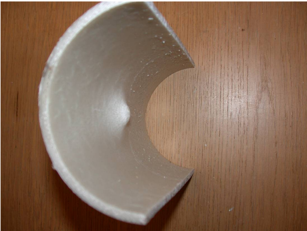
Figur B2-19. Provenance KM1 med 15 % kulintryckning i icke åldrat material M.
