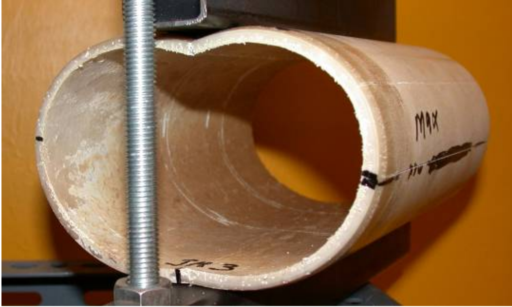
Figur B2-7. Ovaliseringsprov JM3 med notchdjup 10 % i åldrat material M.
