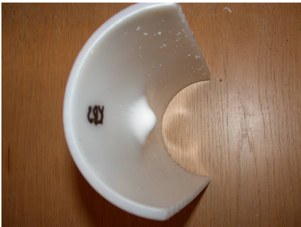
Figur B2-15. Prov KB2 med 25 % kulintryckning i icke åldrat material B.
