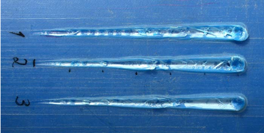
Figur B3-17. Repa 1-3 för rör benämmt Hallingplast.
