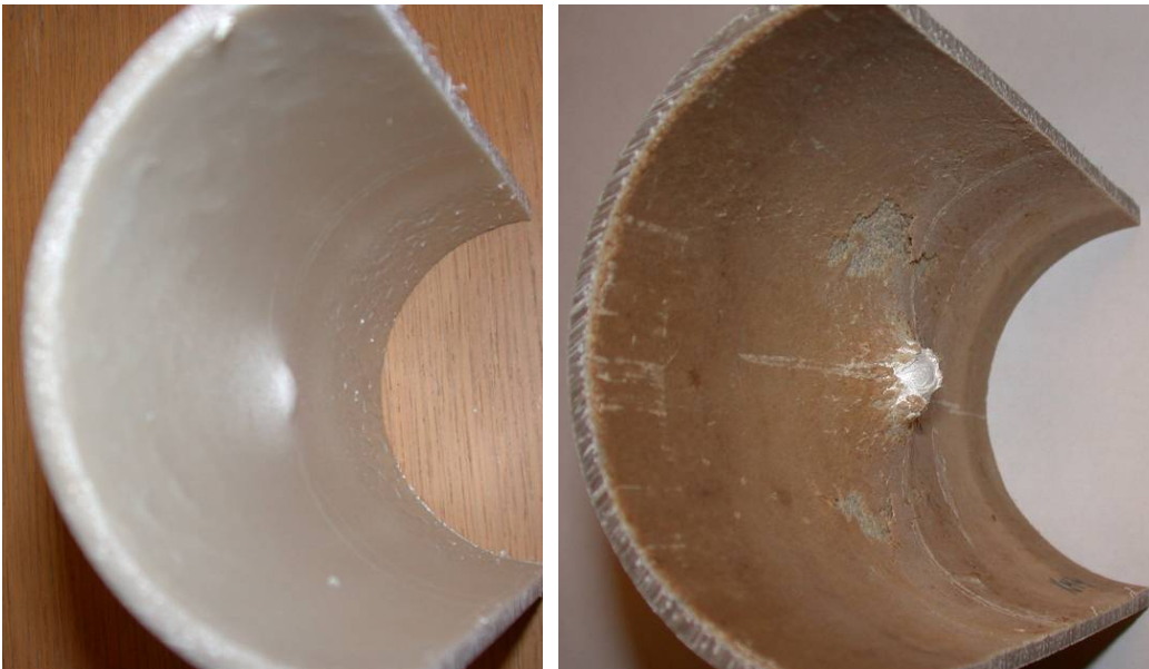
Figur 4-15. Intryckning insida prov KM5 (a) och intryckning insida prov KM4 (b).
