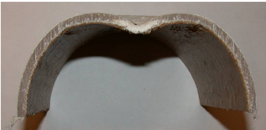
Figur B2-32. Prov KM3 15 % kulintryckning i åldrat material M.
