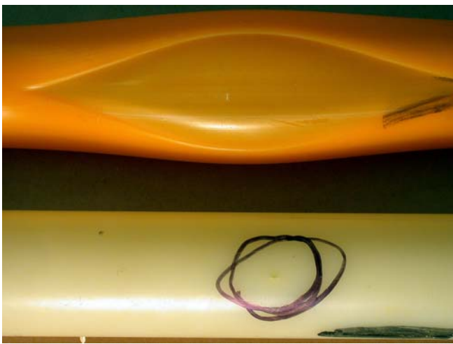
Figur B1-1. Exempel på segt och sprött brott.
