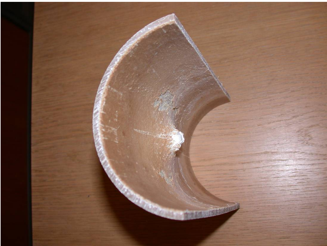
Figur B2-23. Provenance KM4 med 25 % kulintryckning i åldrat material M.
