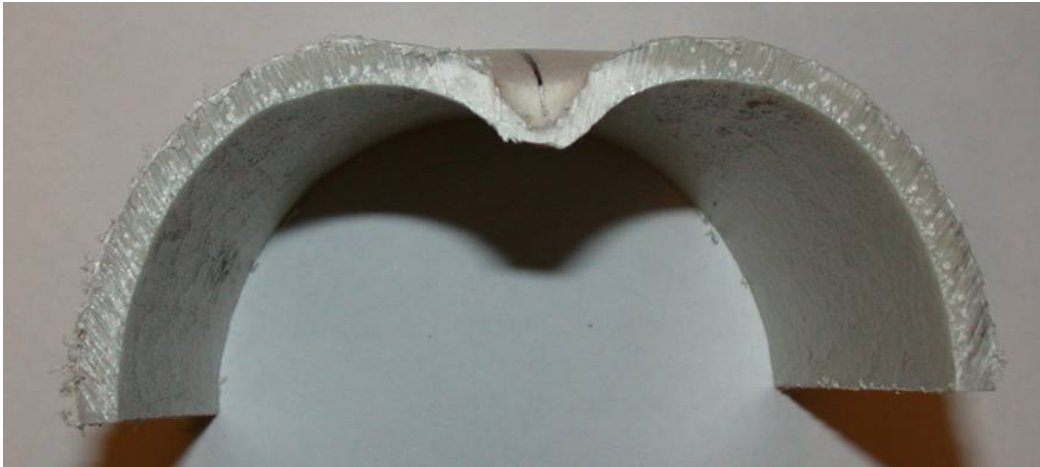
Figur B2-30. Prov KM2 25 % kulintryckning i icke åldrat material M.
