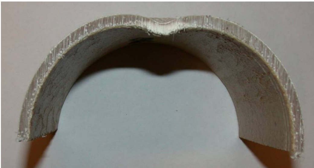
Figur B2-31. Prov KM6 10 % kulintryckning i åldrat material M.
