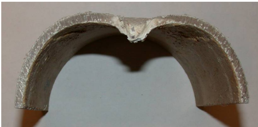
Figur B2-33. Prov KM4 25 % kulintryckning i åldrat material M.
