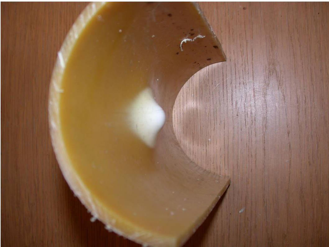
Figur B2-17. Prov KB4 med 25 % kulintryckning i åldrat material B.
