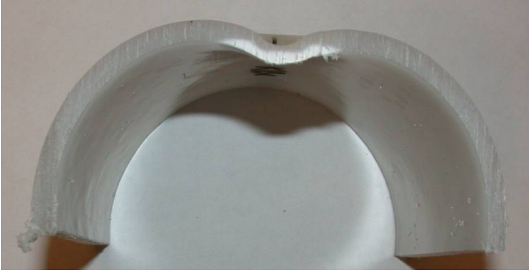
Figur B2-24. Prov KB1 kulintryckning 15 % i icke åldrat material B.
