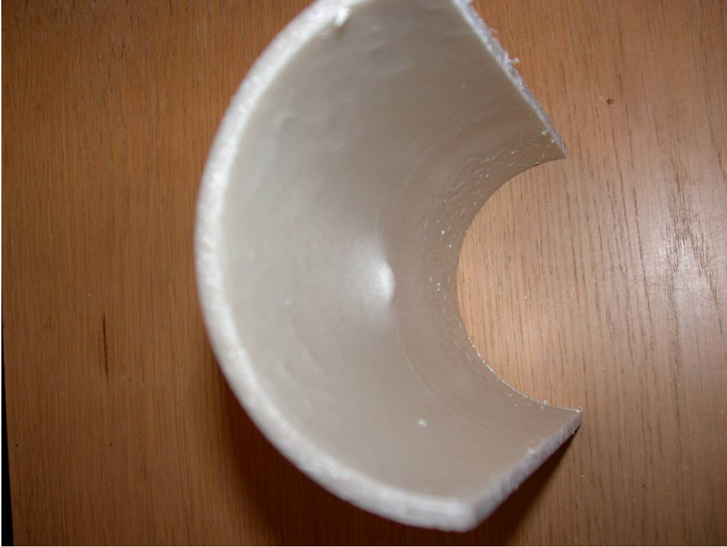
Figur B2-18. Provenance KM5 med 10 % kulintryckning i icke åldrat material M.
