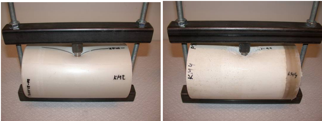
Figur 4-13. 25 % intryckning i icke åldrat prov KM2 bild (a) och 25 % intryckning i åldrat prov KM4 bild (b).
