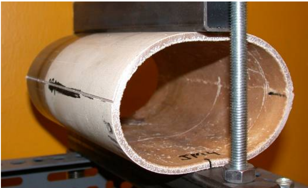
Figur B2-8. Ovaliseringsprov JM4 med notchdjup 20 % i åldrat material M.
