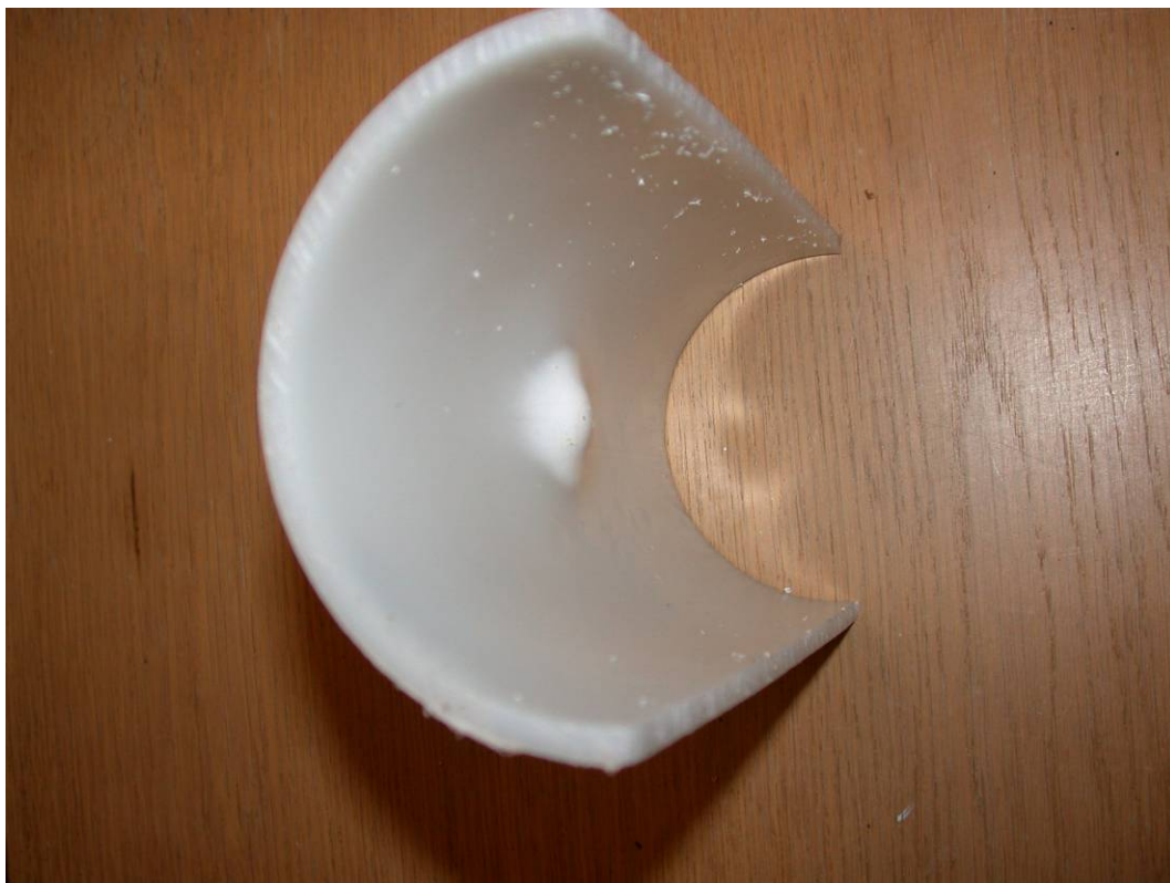
Figur B2-14. Prov KB1 med 15 % kulintryckning i icke åldrat material B.
