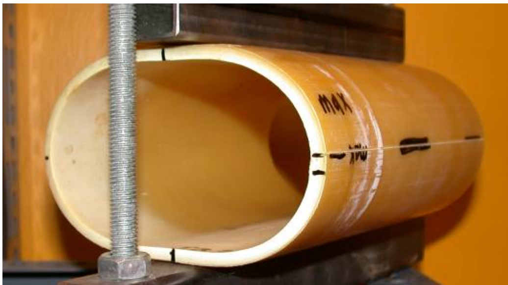
Figur B2-3. Ovaliseringsprov JB3 med notchdjup 10 % i åldrat material B.
