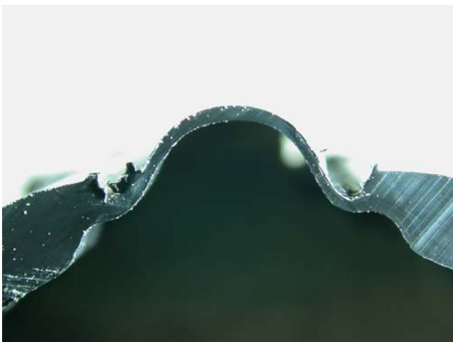
Figur B1-2. Närbild på genomskärning av segt brott.
