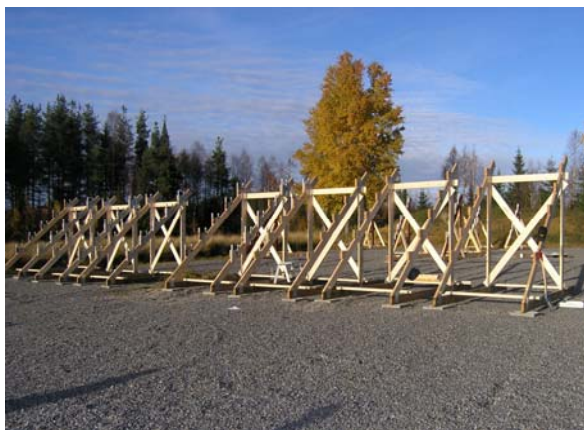
Ställningar för uppläggning av mindre balkbitar.
