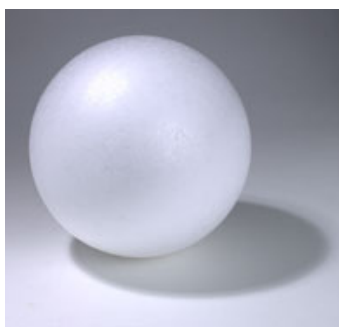
Figur 2.1: Här visas en nyproducerad sfär av EPS. Dessa små sfärer återfinns som ballast i EPSCement. [3.1]
