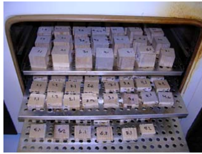
Figur 5.6: Bilden ovan visar gradientproverna, upplagda i torkugnen.
