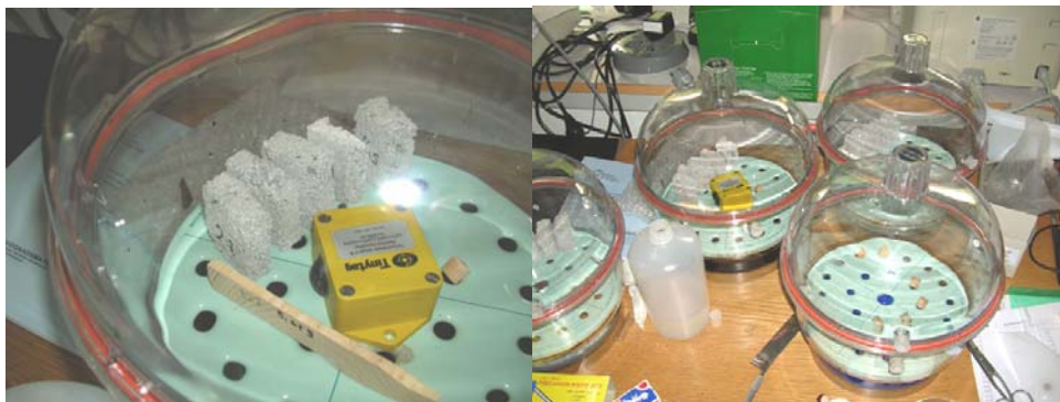
Figur 5.7: EPSCementproverna utplacerade i exikatorerna, samt den utplacerade TinyTag, RF logger.
