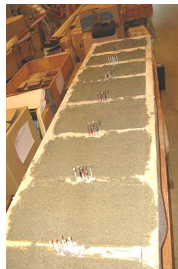
Figur 5.3: Provenheten alldeles efter att igjutningen av EPSCementen var slutförd.
