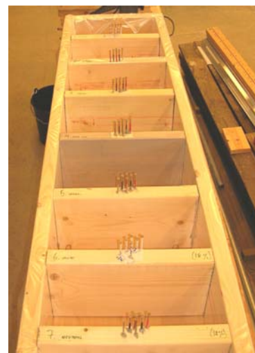
Figur 5.2: Provenheten i sin helhet med de sju provkropparna utplacerade.
