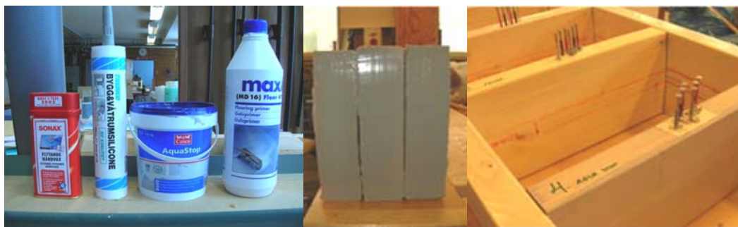
Figur 5.4: Fuktavvisande produkter som applicerades på provkropparna samt ändförsegling och inpassning.
