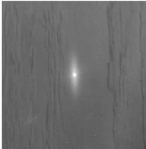
Figur 2. Avlång ljusfläck, utdragen i fiberriktningen, som bildas av en rund laserstråle då den träffar virkesytan..
