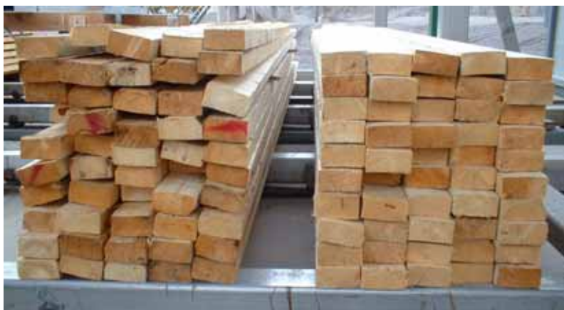
Figur 23. Virke torkat utan och med tryckbelastning.
