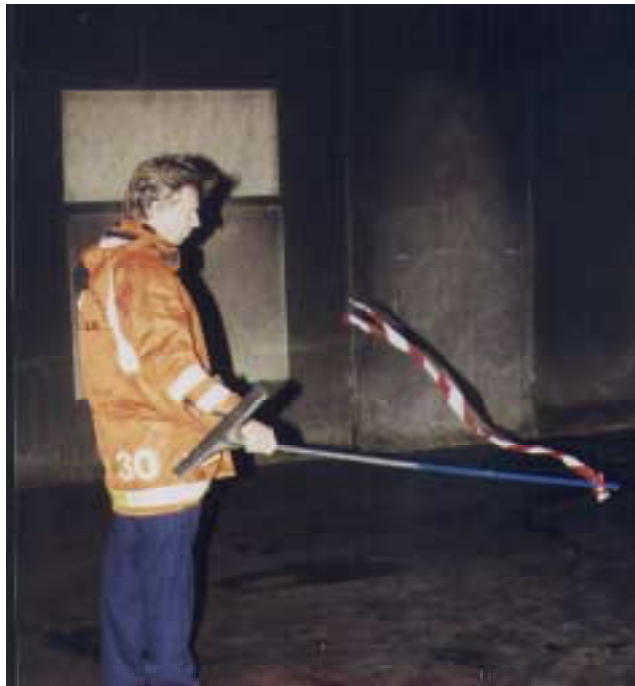
Figur 7 Luftströmmarna i rummet dokumenterades under försöken
