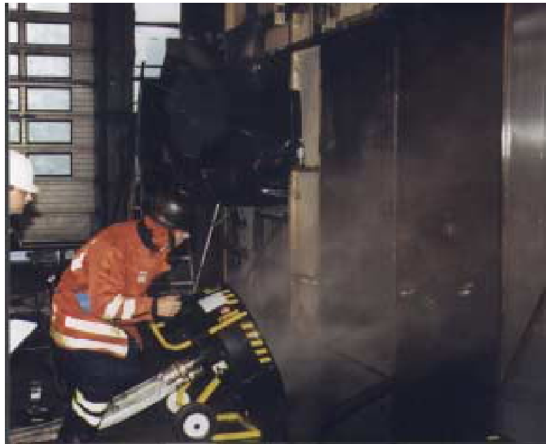
Figur 3 En vattenturbinfläkt placeras vid tilluftsöppningen i Försöksrum 2 . En injekterad vattenstråle visar tydligt hur luftkonen täcker in tilluftsöppningen.
