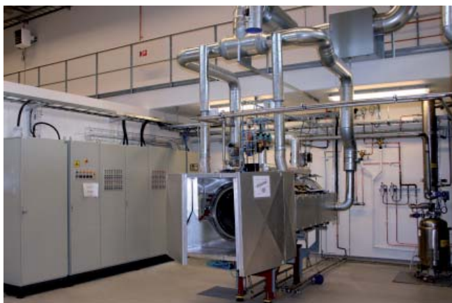
Pilotanläggning för kemisk modifiering genom acetylering. Foto: Anders Clang.
