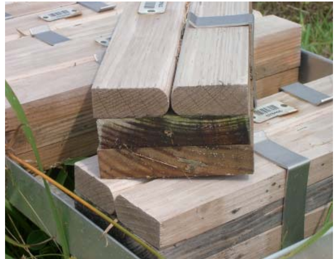
Alternativ konfiguration av provkroppar i den så kallade sandwich-metoden som är aktuell för vidare utveckling i ett Wood-Build-projekt på SP Träteknik.
