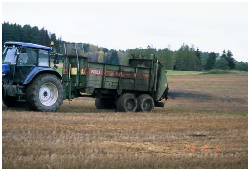
Figur 15. Spridning av fuktig aska med fastgödselspridaren. Det uppmättes en relativt stor giva rakt bakom maskinen.
