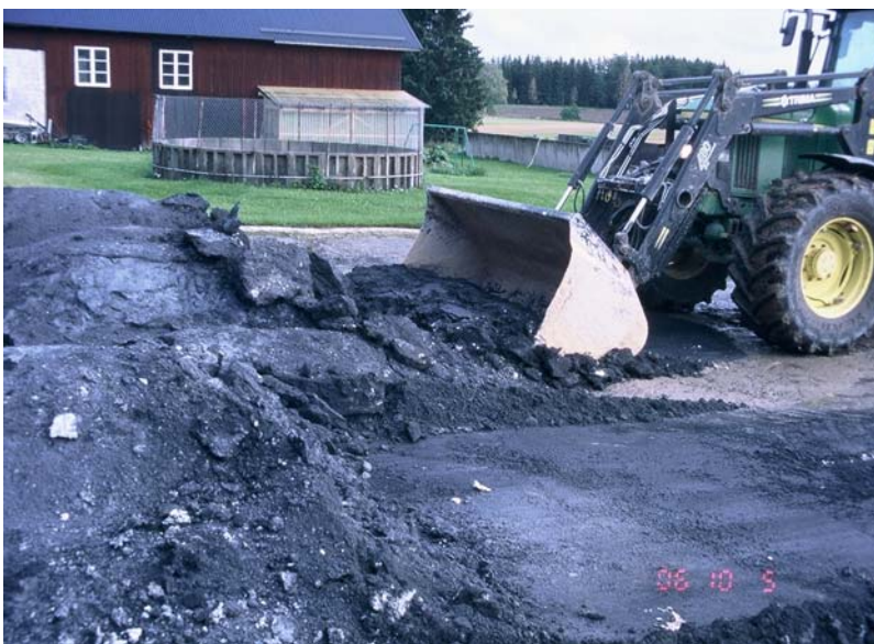
Figur 9. Vid lastning av den fuktiga askan var det nödvändigt att krossa de stora block som hade bildats under lagringen på gödselplattan.
