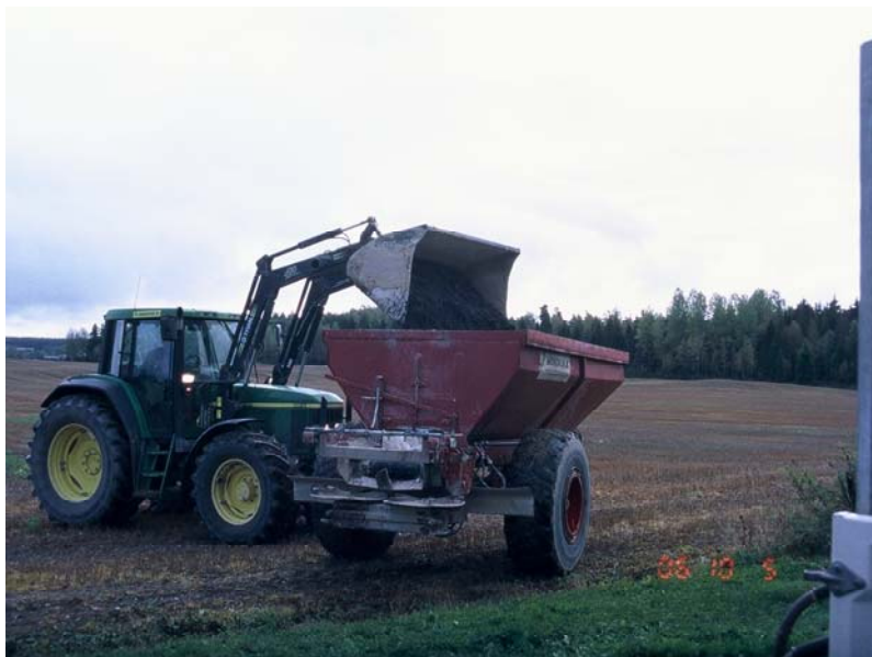
Figur 2. Vy av kalkspridaren bakifrån som visar lastutrymmets avsmalnande form.
