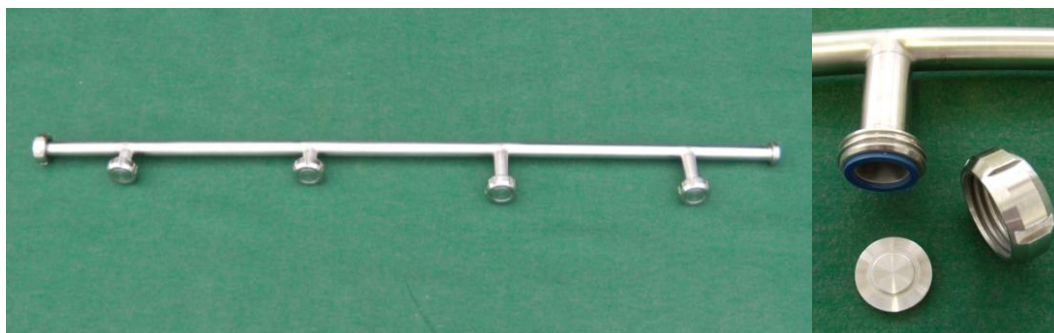
Bild 3. Provrigg med två korta och två långa T-rör, i vars ändar de demonterbara provtagningsbrickorna (t.h.) skruvas fast.
