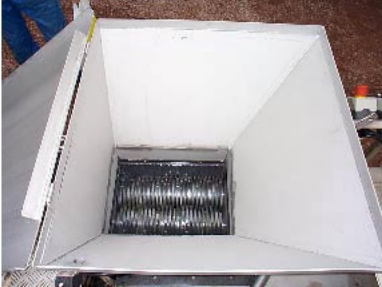
Bild 3. Kvarn för matavfall, placerad ovanpå tippfickan.
