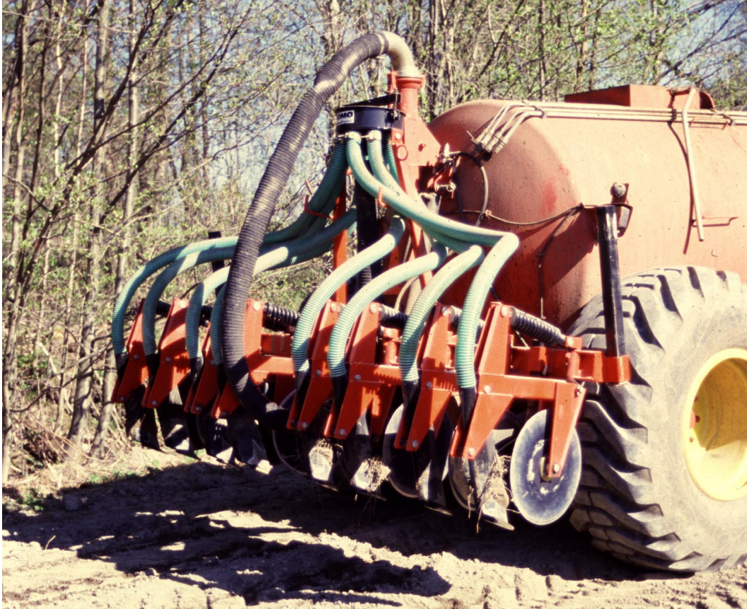
Bild 7. Myllningsaggregat som använts för att sprida våtkomposterat material.
