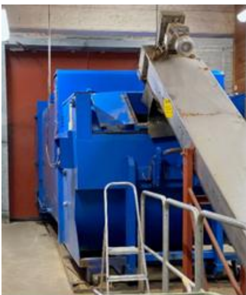
Figur 7. Mobil komprimator 18 m 3 på K1.
