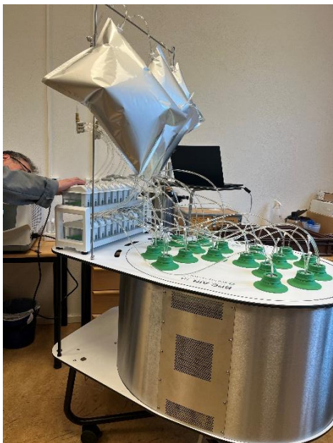
Figur 3. Mätning av biologisk aktivitet i jord från fältförsök med olika typer av hästgödsel med hjälp av en respirometer. Glasflaskor med jord är placerade under den vita skivan, en under vardera grön plastkrage.
