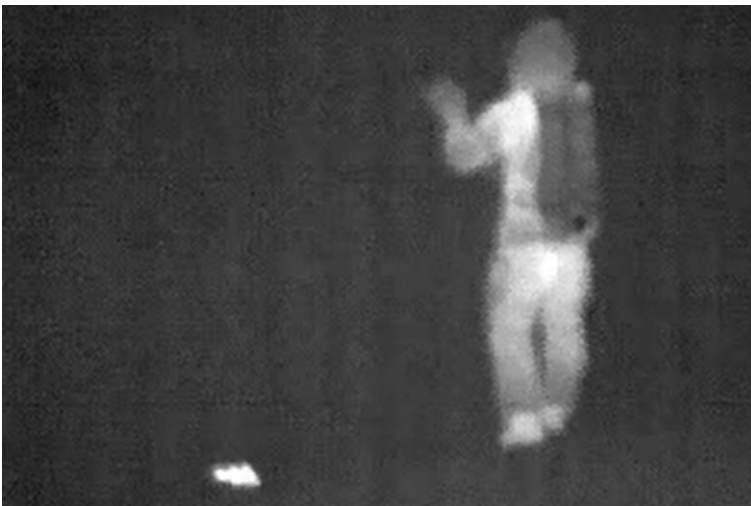
Figur 7. Värmekuddar synliga med värmekamera.
