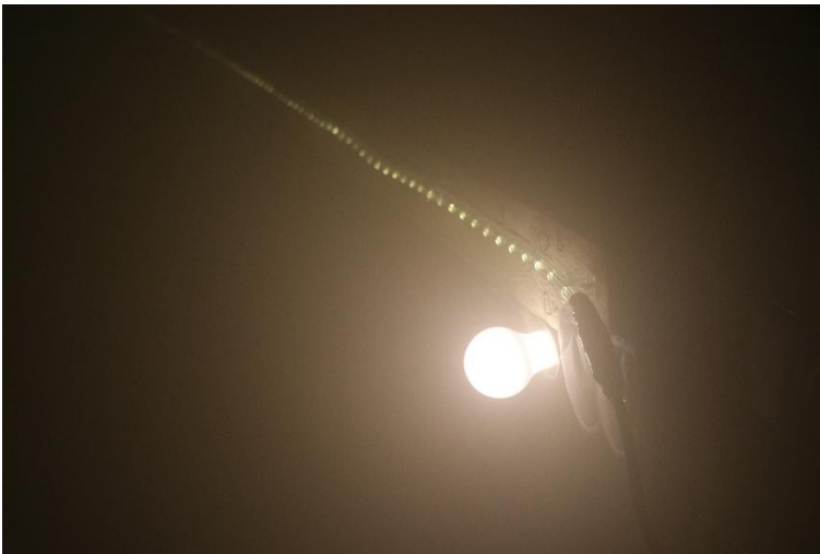
Figur 5. Belysningsarmaturer i rökfylld miljö. Under respektive delförsök var endast en typ av armatur tänd.
