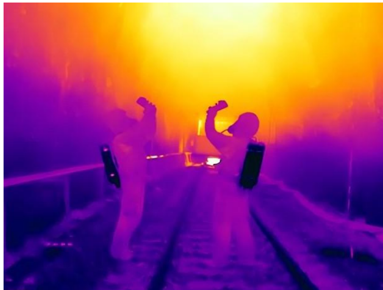
Figur 13. Temperaturmätning med värmekamera.
