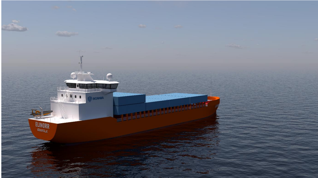
Figur 9. En översiktbild på fartygskonceptet med last ovanpå lastluckorna.
