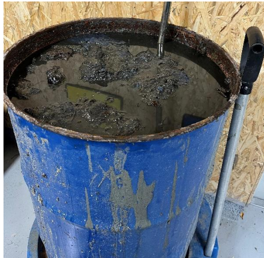
Figur 6 Årsmängden insamlad material från gallerdurken i en spolplatta som renar vatten från ca 300 båtar. Detta motsvarar ungefär den mängd material som en spolplatta undantar från att släppas ut i havet
