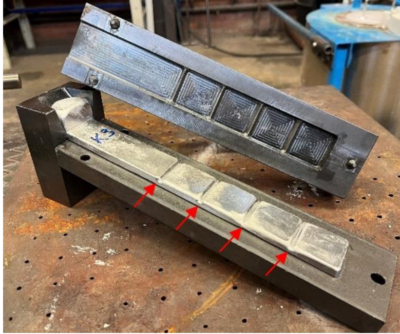
Figur 5: K-mould-verktyget och ett gjutgods som ska brytas upp och utvärderas. Provet bryts vid pilarna.
