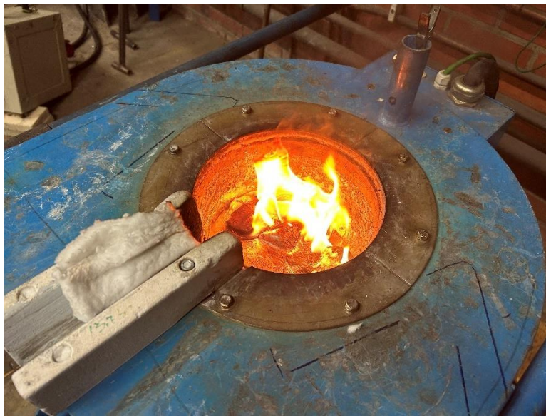
Figur 3. Bild från försök hos RISE Jönköping där ca 2 kg briketter tillsattes till 8 kg smält aluminium.
