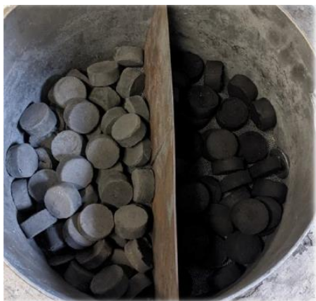
Bild 6: Prover förberedda för reduktionstest 2. Slagg till vänster och glödskal till höger.
