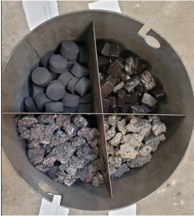
Bild 2: Prover förberedda inför reduktion med GreenIrons teknik.
