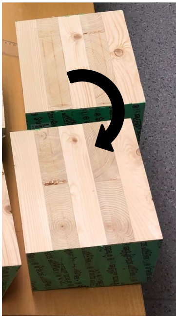
Figur 4. Kombinerad provkropp, skarv i bjälklag. Kanterna är förseglade. Pilen visar att provytorna läggs ihop direkt efter vattenbelastning. Skarven mellan de förseglade kanterna tätades med tejp. Provkroppens ovansida och undersida förseglades inte eftersom de representerar bjälklagets ovansida och undersida. I fältstudien släppte tejpens i vissa fall och vatten rann ner i skarven.
