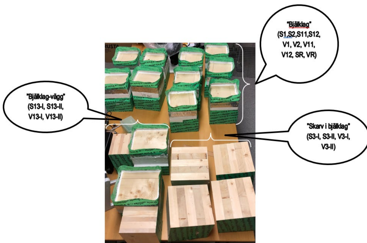
Figur 6. Samtliga provkroppar inför applicering av spörlösning samt provkropparnas beteckning. Varje provkropp består av två provdelar (springa i bjälklag respektive ovasida av bjälklag eller ändträ respektive tvärs fiberriktning).
