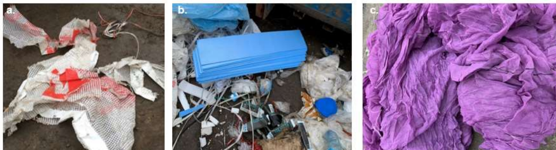
Figur 16a. Felsorterad armerad plast som togs bort före inmatningen. 16b. Felsorterad plast som måste tas bort före inmatningen. 16c. Felsorterat plastnät, troligen av polyamid eller polyester, som sorterades bort före inmatningen.
