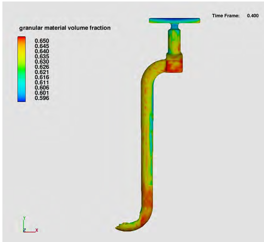
Figur 6: Visar ett mått på packningsgrad för ventil 1-3 öppen.
