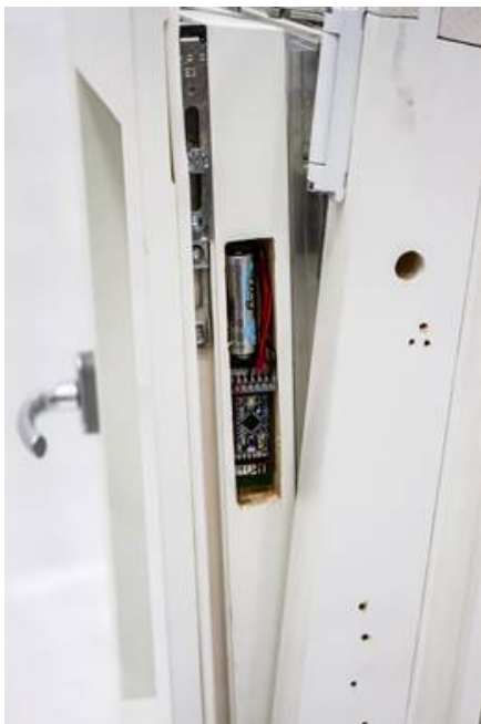
Figur 6: Elektronik och batteri för det autonoma dynamiska fönstret kan antingen sitta i ett litet hålrum i fönsterbågen (se foto till vänster ovan) alternativt kan elektronik och batteri sitta i en liten box på fönsterbågen, då kan den i vissa fall tom installeras i efterhand på ett redan installerat fönster (se foto till höger ovan).
