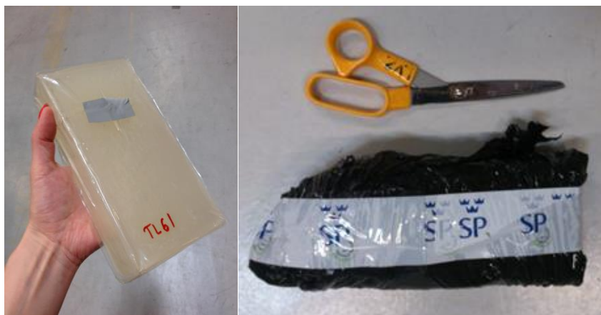
Figur 7 "Matpaketet", till höger med temperaturgivare inuti och invirad i tejp för att inte misstas för en vara av handlande kunder.
