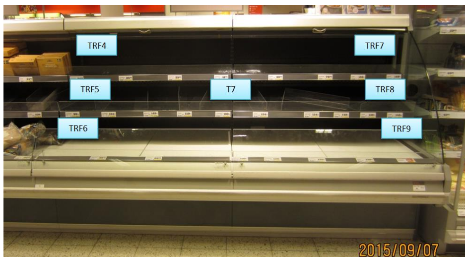
Figur 10 Temperaturmätarnas placering i kyldisken.
