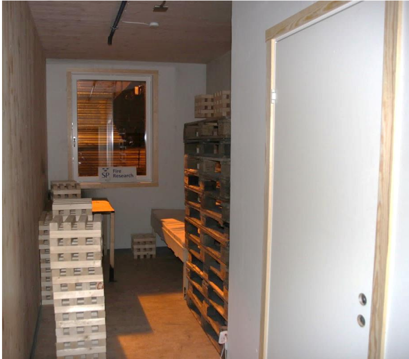
Figur A- 3: Oversikt over plassering av brensel inne i hybelen i forsøket. Brannen startet under pulten til venstre i bildet, i et kar med heptan med en trekrybbe over.
