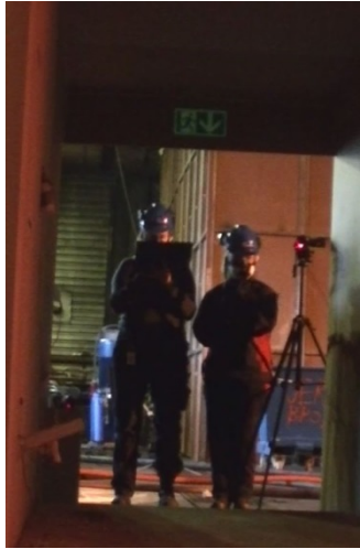
1:50: Etterlysende skilt med piktogram ikke lengre synlig
