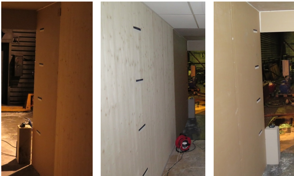
Figur 2-5: Høyde og dybdemarkører, tegnet opp i fire høyder og tre dybder på korridorveggen. Bildene viser markører A-D (venstre bilde), markører E-H (senterbilde) og markører I-L (høyre bilde).
