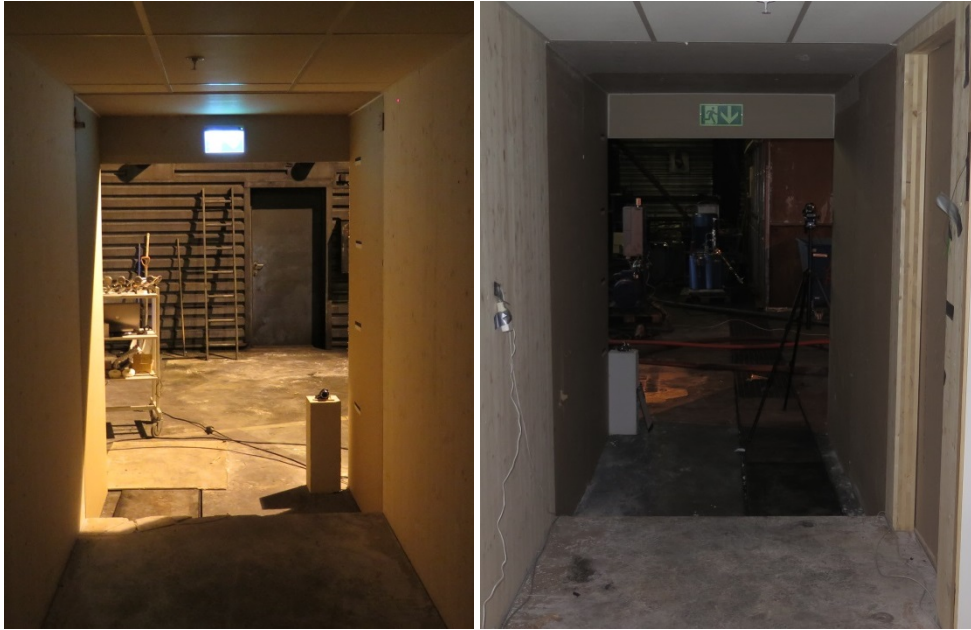
Figur A- 6: Forsøk 2. Elektrisk markeringsskilt montert på venstre korridorside (venstre bilde). Etterlysende markeringsskilt montert på høyre korridorside (høyre bilde).
