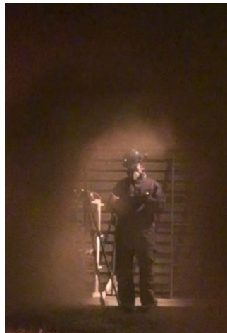
4:34-4:40: Elektrisk skilt: Piktogram, skilt og lys/glød ikke lengre synlig
