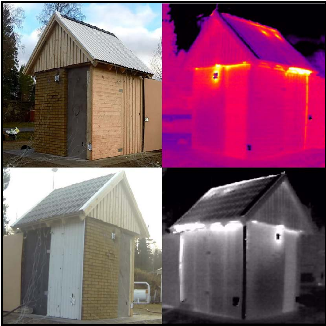
Figur 5: Bilderna visar hur det ser ut från utsidan av byggnaden 10 sekunder in i brandförloppet. IR-bilderna är från Dräger 9000-kamera (ovan) och Dräger 7000-kamera (nedan). Bild tagen från Gudmundsson och Studahl (2015), sidan 43 [21].
