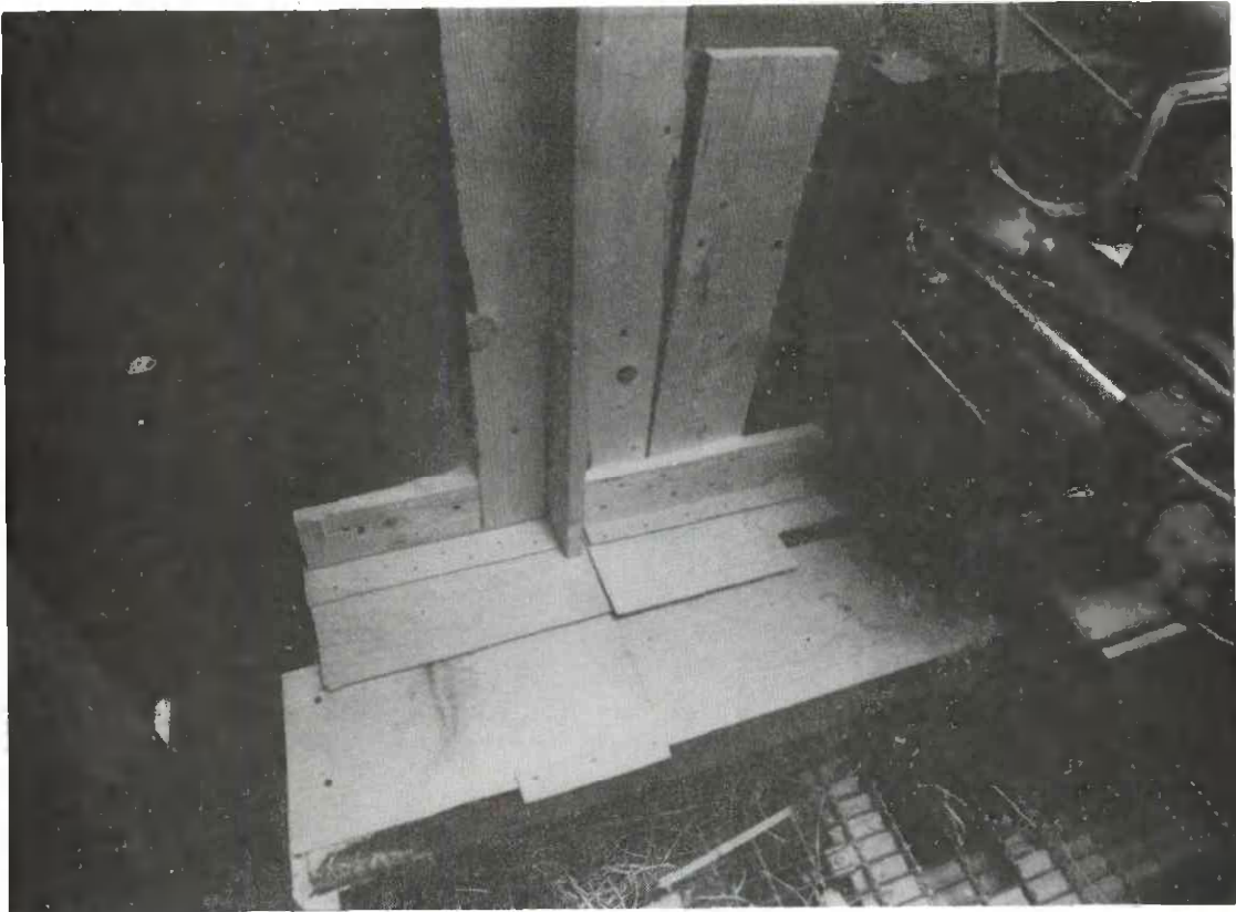
Anslutning mot stup och arbetsplan i driftläge. Sågarna skall då vid ompostning kunna förskjutas sinsemellan, vinkelrätt mot bildens plan.
