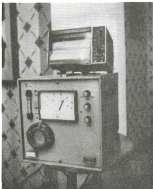
Figur B1. Instrument som registrerar och skriver ut gaskoncentrationen.
