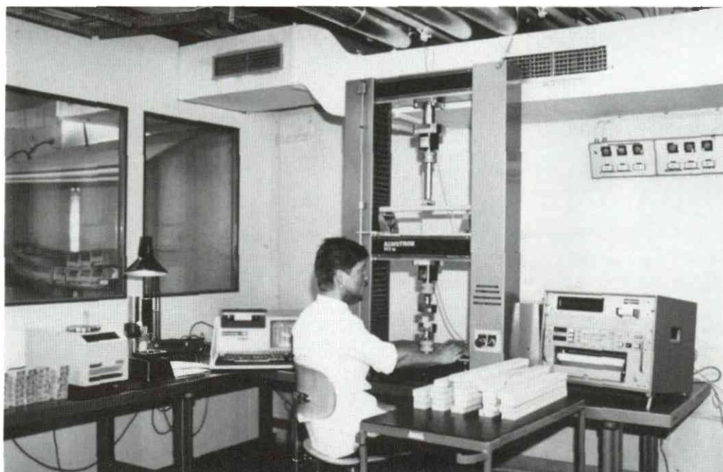
Figur 7.1. Testing av sponplater med Alwetron universal prøvemaskin.
