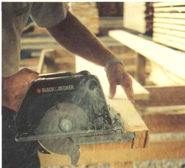
Figur 4. Kapning av lameller från plankänden för bestämning av sprickans läge och längd.
