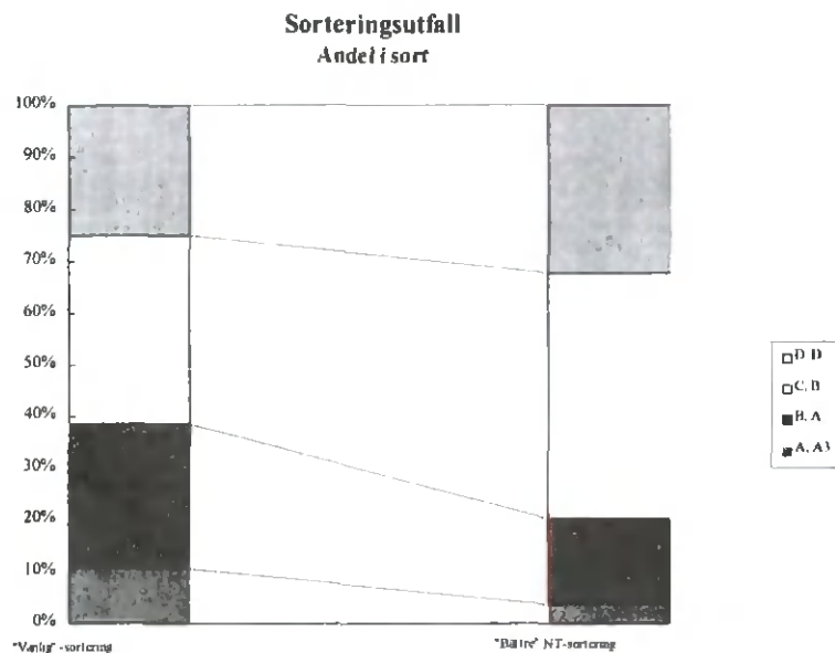
Figur 5. Figuren visar hur utfallet ändras med ändrade sorteringsregler. Sorteringsreglerna i den "bättre" sorteringen är skaprade för kviststorlekar jämfört med "vanliga" Nordiskt Trä, övriga särdrag lika.
