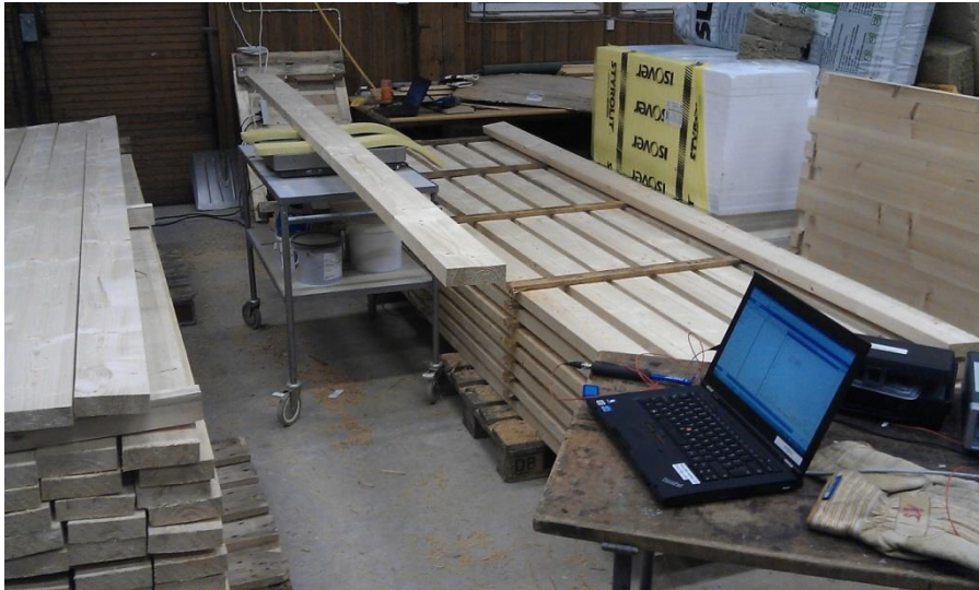
Figur 1: Mätupställning. Plankorna placeras på mjuka sylomerer i mitten, på våg. Knackning sker med krafthammare i plankans längdriktning, på sida utan borrhål. Mikrofon hålls i anslutning till samma ände som knackning sker.
