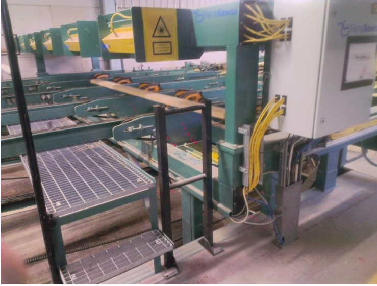
Figur 8: RemaSawcos tvärsmatade fibervinkel- och bildskanner.
