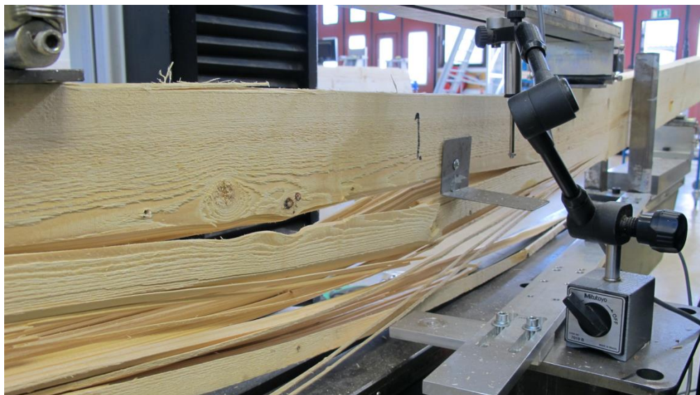
Figur 13: 4-punktsböjtest enligt standard SS-EN 408-2010 vid SP testlaboratoriet i Skellefteå.
