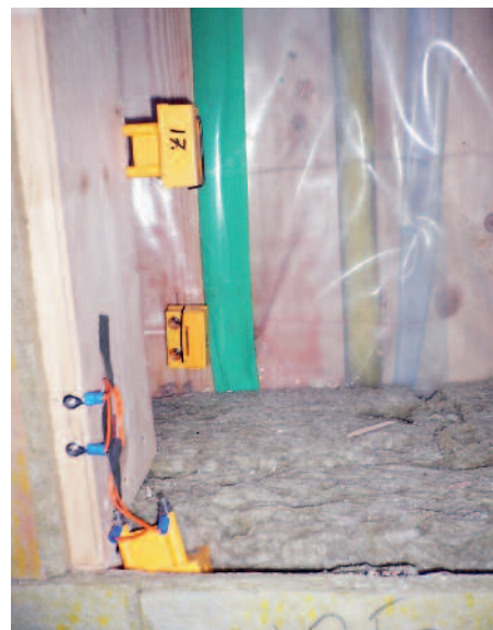
Bild 1: Installerade sensorer vid utsida väggregel, mitt i väggen och vid utsida plastfolie/luft- och ångspärr.
