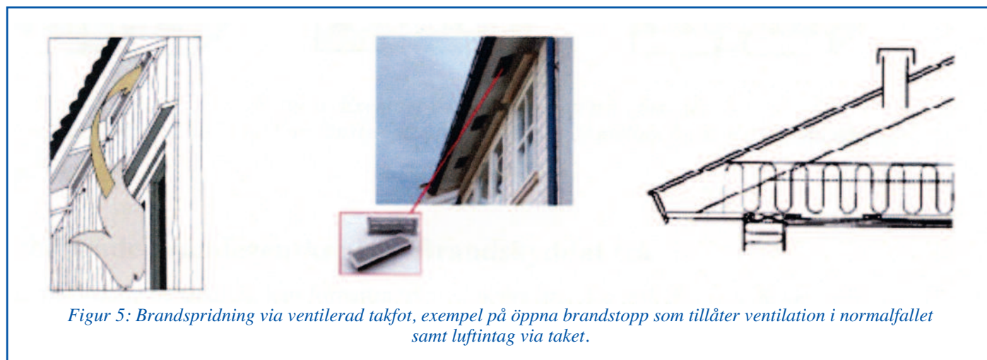
Figur 4: Exempel på brandstopp i utvärdiga hålrum.
