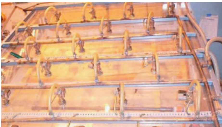
Bild 1. Pågående provning av regntätethet hos ett underlagstak med genomföringar och skarvar, Olsson (2009).
