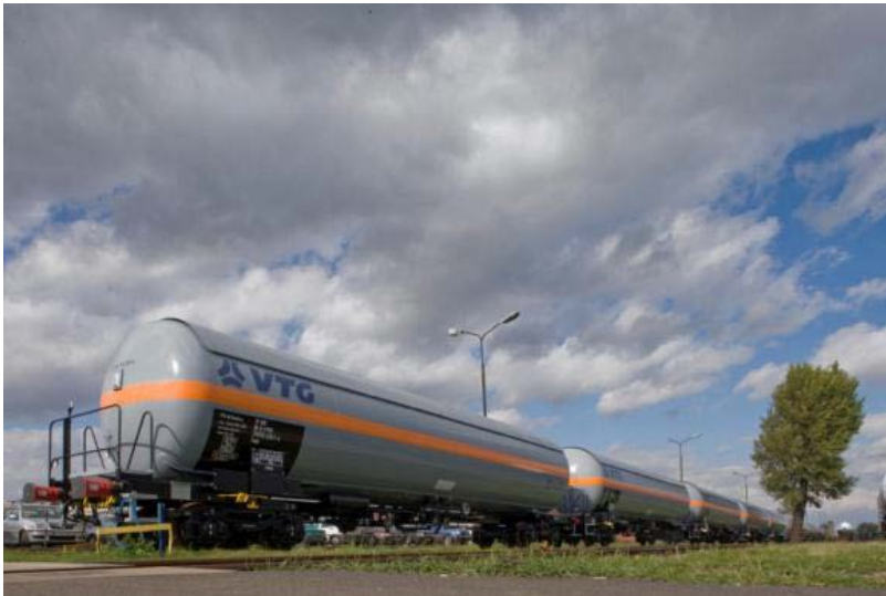
Tankvagnar för LNG (Liquid Natural Gas) (7)
