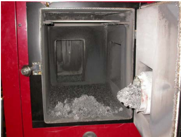
Figur 3. Förbränningsrummet efter försöket utan additiv. Brännarröret sticker in genom luckan till höger.
