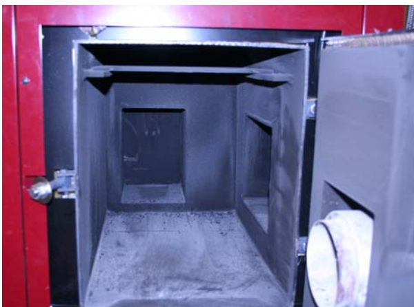
Figur 4. Förbränningsrummet efter försöket med kalkstensmjöl. Brännarrör och väggar är täckta av ett vitt pulver.
