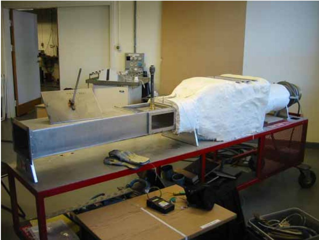
Figur 10 Exempel på vindtunnel för bestämning av RTI värde (LTH, foto Joel Blom). Provobjektet placeras i luftströmmen strax efter den isolerade delen.
