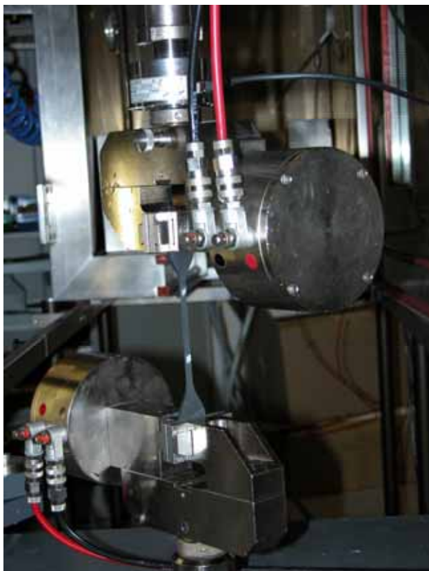
Figur 7 Dragprovningstrustning med provobjekt.
