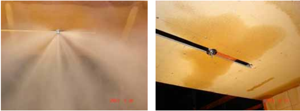
Figur 16 Närbild av området runt sprinklern och vätningen av takytan efter försöket. Observera att takytan närmast väggen erhöll vätning av uppvirvlande vatten.
