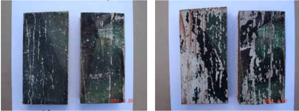
Figur 23 Försök A1 med sprinkler. Opåverkade (till vänster) och påverkade provkroppar. Provkropparna till vänster i respektive foto var placerade i den övre positionen.
