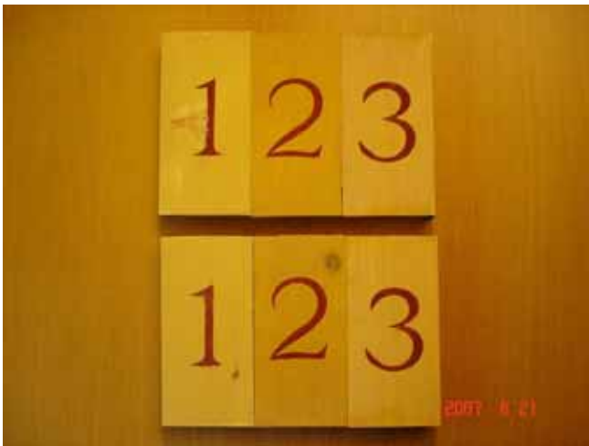
Figur 19 Provkroppar efter Försök N2 med vattendimma (lågtryck). Vid nedmonteringen berördes ytan oavsiktligt så att färgen släppte på den övre provkroppen med limfärg (Nr 1). En kvist framträder på provkropp med äggoljetempera (Nr 2) som var placerad på den nedre nivån. På båda provkropparna med oljefärg (Nr 3) har kulören mörknat vid övre och nedre kanten.
