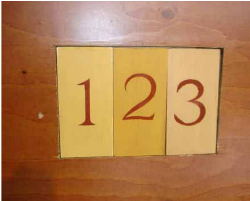
Figur 10 Montering av de nytillverkade provkropparna genom en öppning i väggskivan, 1) limfärg, 2) äggoljetempera på kredering och 3) oljefärg.
