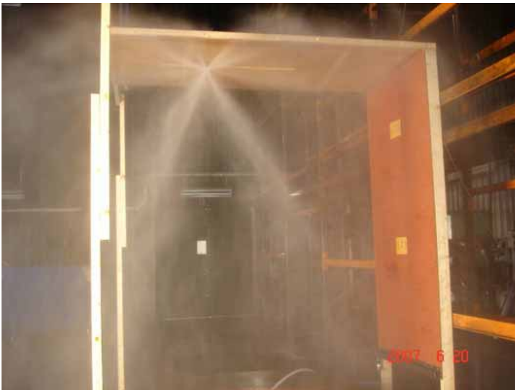
Figur 13 Spridningsbild från munstycket vattendimma (lågtryck) vid 15,0 bars tryck (24,4 L/min). Fotot taget vid försöket med nytillverkade provkroppar, Försök N2.
