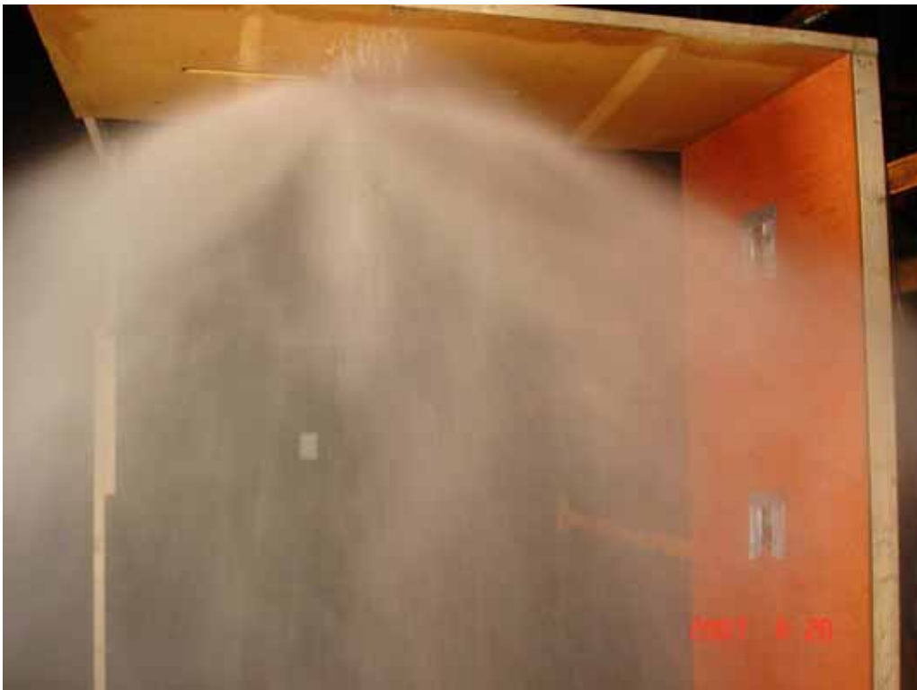
Figur 11 Spridningsbild från sprinklern vid 5,0 bars tryck (179 L/min). Fotot taget vid försöket med autentiska provkroppar, försök A1.
