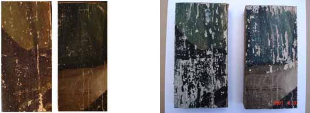
Figur 25 Försök A3 med vattendimma (högtryck). Opåverkade (till vänster) och påverkade provkroppar. Provkropparna till vänster i respektive foto var placerade i den övre positionen.
