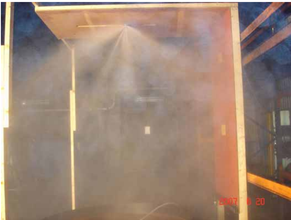
Figur 15 Spridningsbild från munstycket vattendimma (högtryck). Fotot taget vid försöket med nytillverkade provkroppar, Försök N3.
