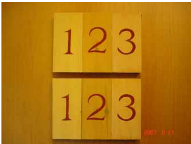
Figur 20 Provkroppar efter Försök N3 med vattendimma (högtryck). Kvistar framträder på båda provkropparna med äggoljetempera (Nr 2). På båda provkropparna med oljefärg (Nr 3) har kulören mörknat vid övre och nedre kanten.
