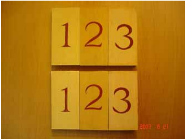
Figur 18 Provkroppar efter Försök N1 med sprinkler. På båda provkropparna med oljefärg (Nr 3) har kulören mörknat vid övre och nedre kanten.
