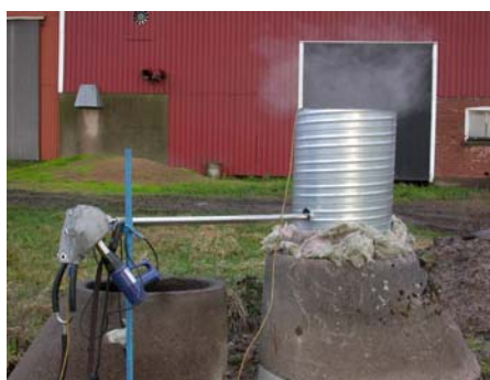
Figur 4. Bilden visar mätsonden monterad i rökgasrörets mynning.
