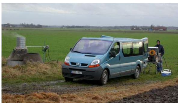
Figur 3. Bilden visar bilen med mätutrustning vid brunnen.
