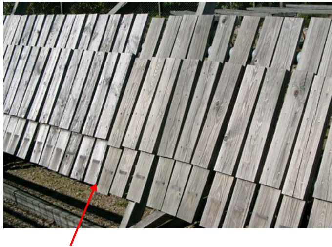
Figur 16 Utseende hos furukärna (till vänster) och CCA-impregnerat trä (till höger) efter 10 år.
