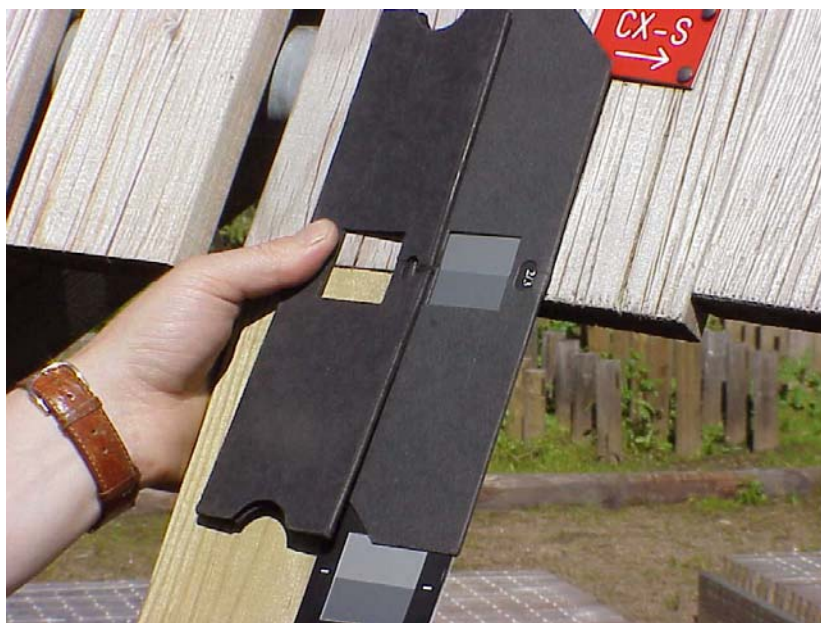
Figur 7 Bedömning av skillnad i kulör mellan prover exponerade på försöksfältet (övre provbit) och referensprover (undre provbit). Skillnaden jämförs mot en standardiserad gråskala till höger i bilden.
