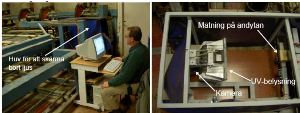
Figur 9: Den industriella prototypen installerad i justerverket vid Malå sågverk.
