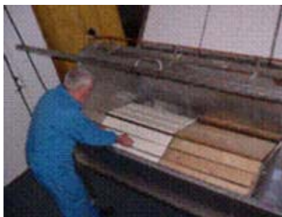
Provning av väderbeständighet för utomhusbruk (Bruksklass EXT) Accelererad åldring t v, Naturlig åldring t h.
