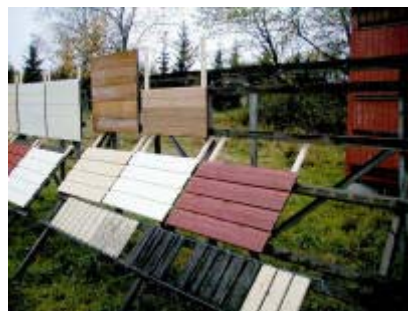
Provning av väderbeständighet för utomhusbruk (Bruksklass EXT) Accelererad åldring t v, Naturlig åldring t h.
