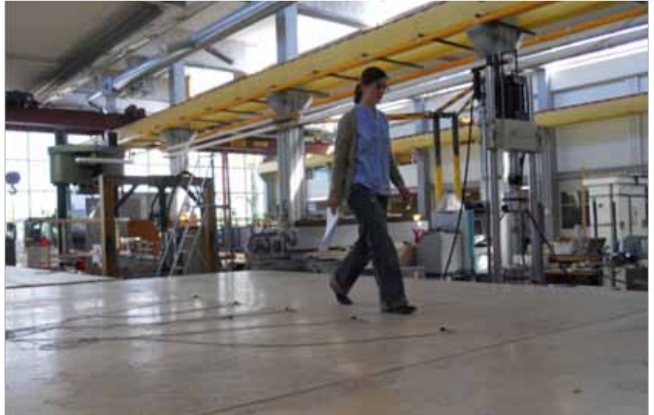
Mätning av vibrationer och svikt i laboratoriemiljö.
