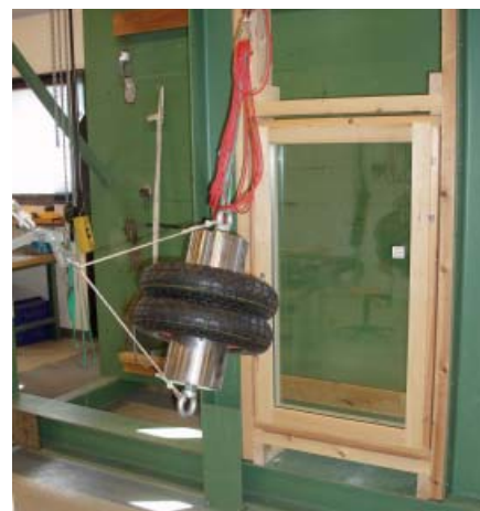
Provning av slagtålighet enligt EN 12600.
