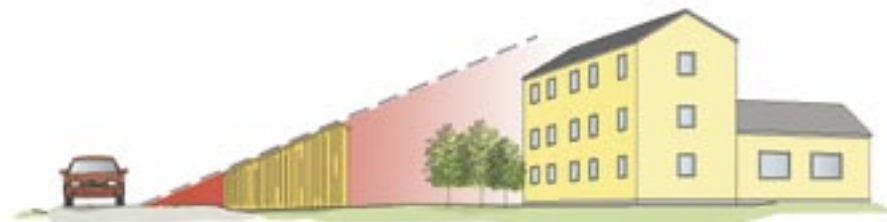
Byggnaden ligger i ljudskugga av bullerskärmen.
