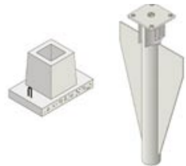
Exempel på betongfundament och pålfundament.
