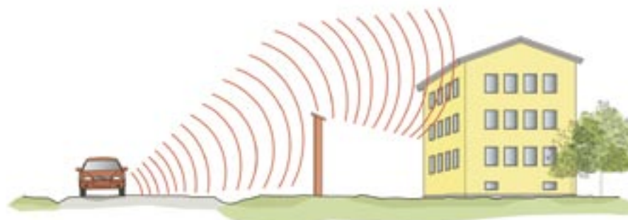
Ljudskuggan är inte fullständig, eftersom en del av ljudet kommer att brytas över skärmens kant och spridas till området i skärmens skugga.
