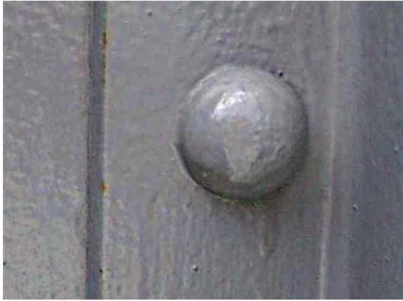
Provyta med färgsystem F0 med St 2 där kant N2 framträder som något påverkad
