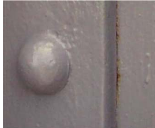
Provyta med färgsystem F6 med St 2 där spalt N1 framträder som klart påverkad
