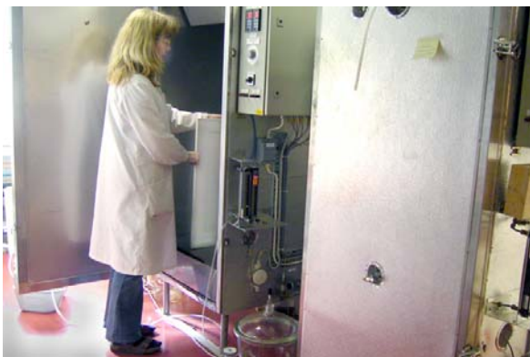
Klimatkammarmetoder för bestämning av formaldehyd utförs bl a enligt den japanska metoden JIS A 1901, europeiska prEN 717-1 och svenska SS 270236.
