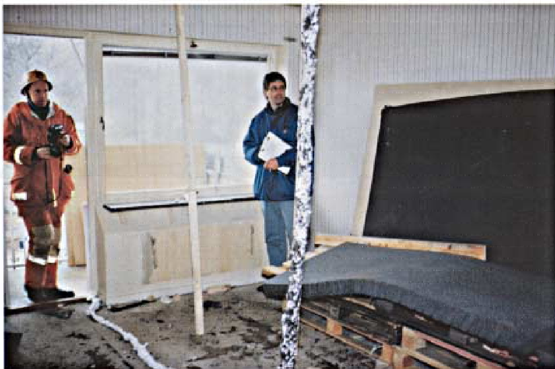
Figur 2 Brandbelastningen i lägenheten bestod av träpallar, spånskivor och madrasser. Brandbelastningen motsvarar den som finns i en normal lägenhet i Sverige.
