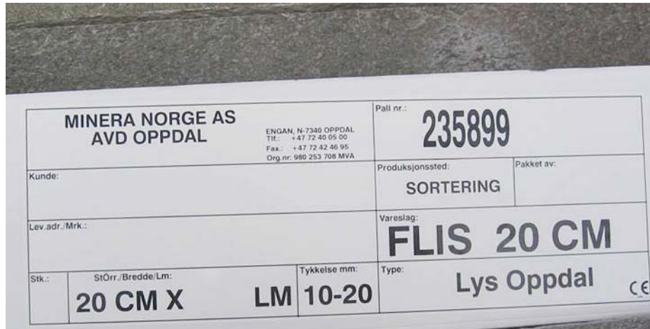
Figur 3. Exempel på märkning av skiffer (från Mineras täkt i Oppdal, Norge). Notera CE-märket i det nedre högra hörnet. Det skall vara tydlig och beständig märkning som bl a håller för transport, regn mm.
